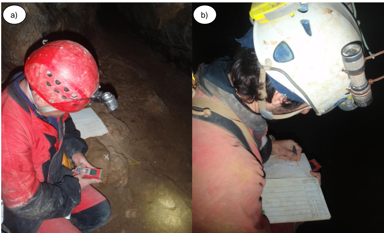
Figura 5.- Levantamiento topográfico de la cavidad: (a) distanciómetro DistoX, (b) toma de datos en la libreta de campo.
