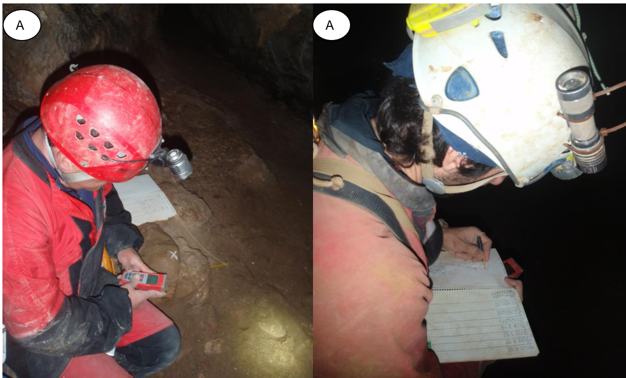
Figura 4.- Levantamiento topográfico de la cavidad: A Distanciómetro DistoX empleado para la toma de datos. B Toma de datos en la libreta de campo, donde se realiza además el dibujo de la cueva.
